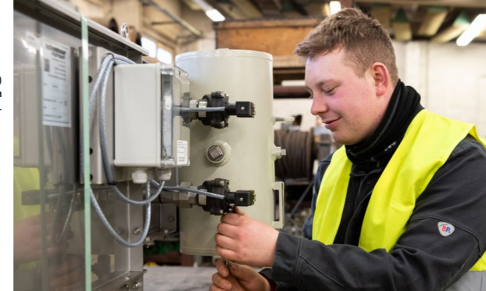
Industriemechaniker Leon Knappe (Foto r.) montiert ein Magnetventil an einem Aspirationsfilter zur Luftentstaubung.
